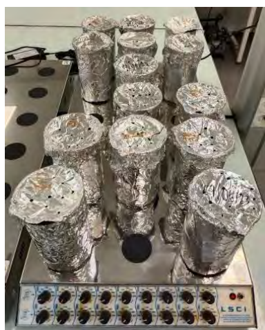
Figure 1. Plaque d'agitation magnétique avec bioréacteurs contenant des échantillons incubés.
