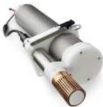
Figure 12. Sonde Contros HydroC CO 2 , équipée sur cette photo de la pompe externe et sa crépine d'aspiration d'eau (cuivrée), et du carter (blanc) abritant la membrane semi-perméable au CO 2 .
