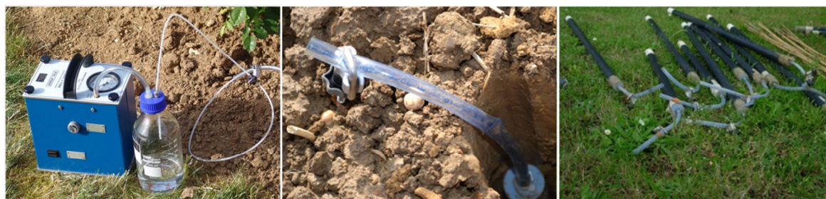
Figure 2. De gauche à droite : matériel de prélèvement de l'eau dans les bougies poreuses, bougie implantée verticalement (10 cm sous la surface du sol), et bougies de 80 cm prêtes à l'implantation.
