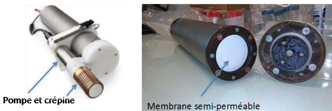
Figure 11 : Sonde Contros HydroC CO 2 , équipée sur cette photo de la pompe externe et sa crépine d'aspiration d'eau (cuivrée), et du carter (blanc) abritant la membrane semi-perméable au CO 2 .
