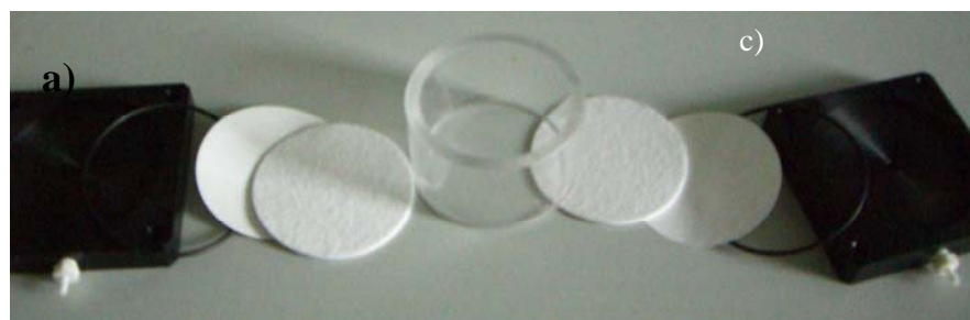
Figure 4. Photos du dispositif de prélèvements du sédiment et d'un réacteur a) Carottier. b) Réacteur avant montage. c) Réacteur monté. d) système complet. (Laverman et al. 2006)
