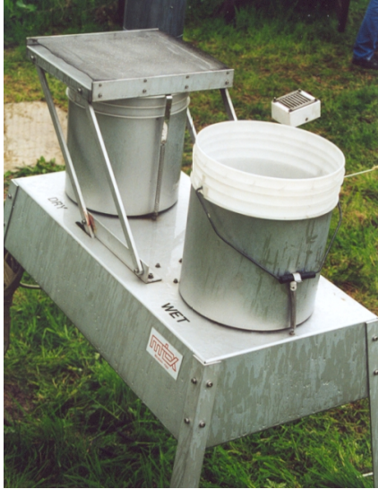
Figure 1. Préleveur ARS 1 000 (MTX Italia)
