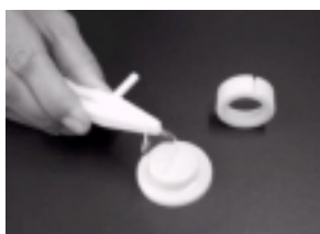
Figure 1. Mise en place sur un support DGT en plastique des différents gels chélatant et diffusif.
