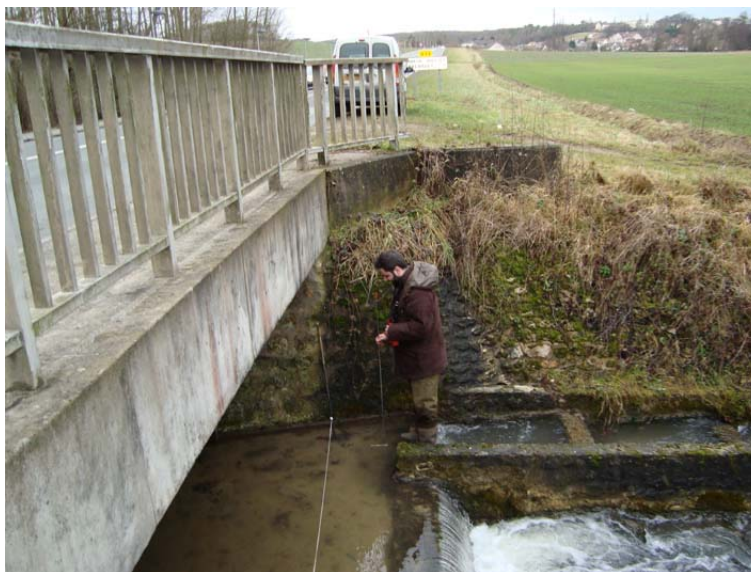
Figure 16 : Mesure du débit avec un micro moulinet à l'exutoire de la Renarde
