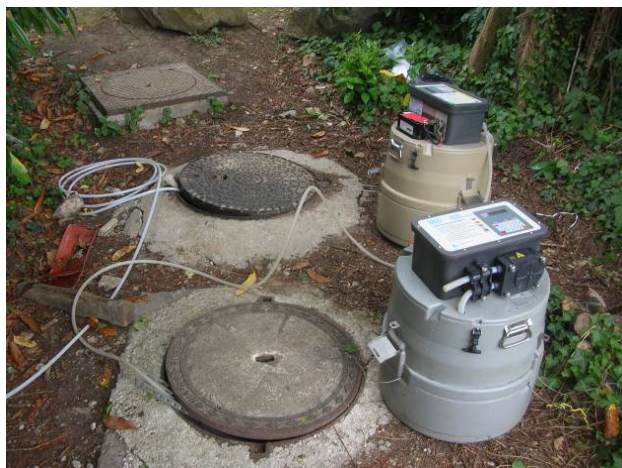
Fig. 7 : Emplacement des préleveurs automatiques sur le site d'études ; collecteur d'eaux usées (en bas) et collecteur d'eaux pluviales (beige, en haut) ; Fig. 8 : Echantillons d'eaux usées
