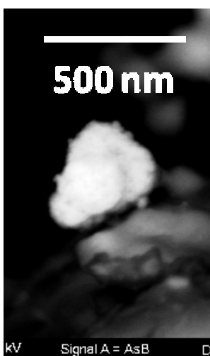
Figure 9 : Image au microscope électronique (MEB-FEG IMPMC) montrant une particule dont la composition est Zn :S 1 :1 (atomique).
