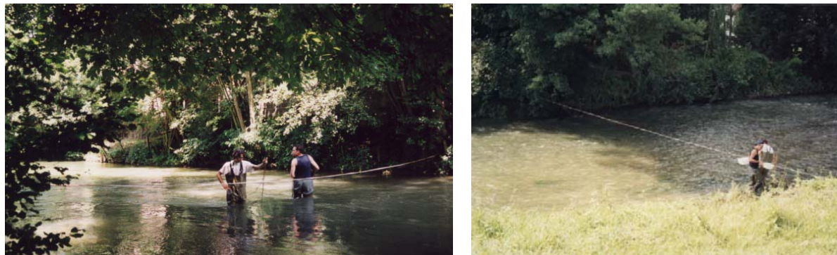
Figure 20 : Mesure de la vitesse à La Bretonnière (12m) au micromoulinet (à gauche) et prélèvement à Pommeuse d'une largeur de 20m (à droite). (Flipo, 2001)
