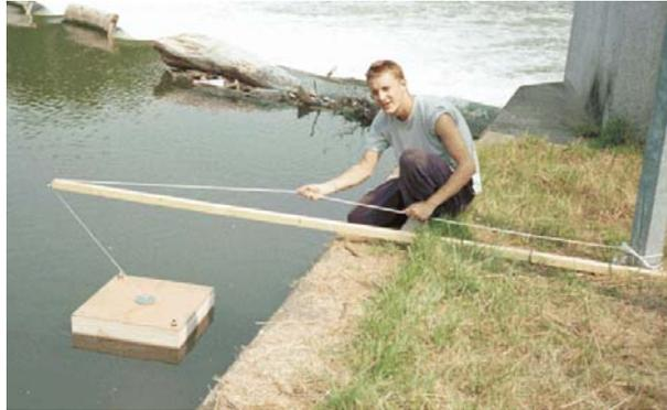
Figure 11 : Piège à sédiment en place au barrage de Denouval
