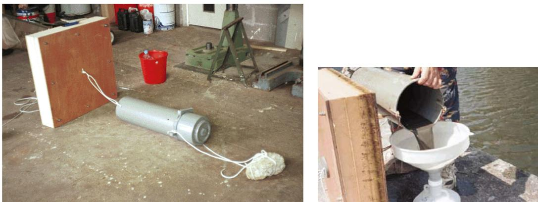
Figure 10 : Piège à sédiment et récupération d'un échantillon
