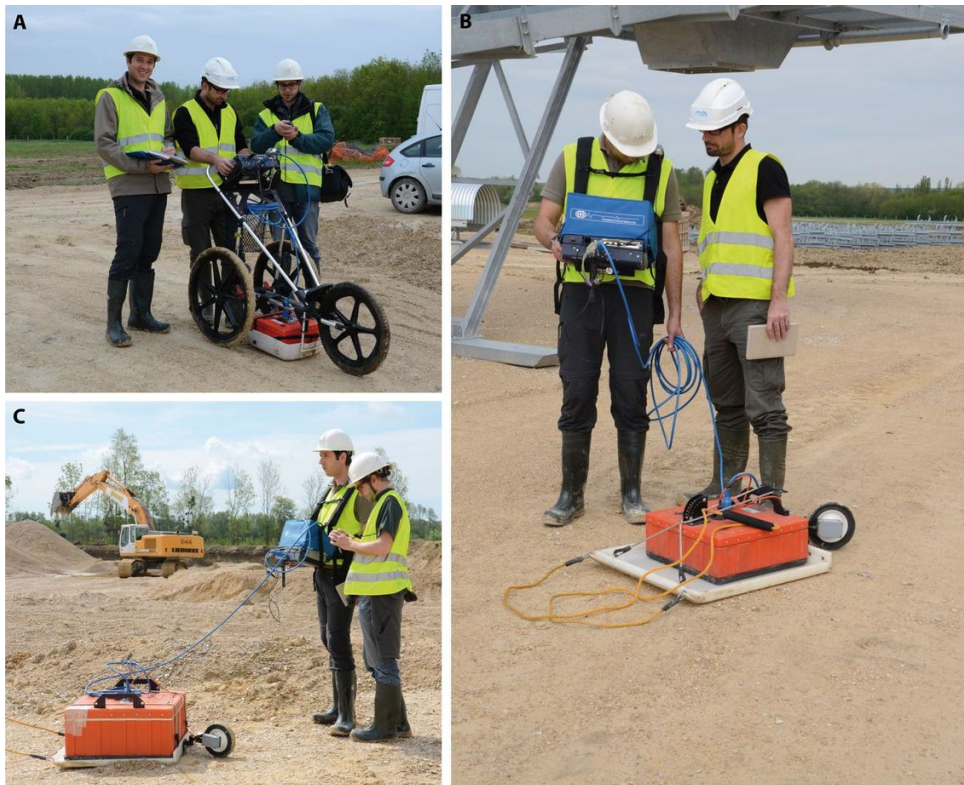
FIGURE 5 – Antennes radar GSSI de 400 (A), 270 (B) et 200 MHz (C) testées sur le terrain. L'antenne de 400 MHz est montée sur un charriot, alors que les antennes de 270 et 200 MHz, plus grandes et lourdes, sont trainées.
