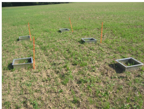
Figure 2 : a) Localisation de la zone de mesures de N_2O et CH_4 en chambres dans le bassin de l'Orgeval ; b) Profil du transect étudié avec les positions de pente (cf. Vilain et al. 2010) ; c) photo des chambres d'accumulation
